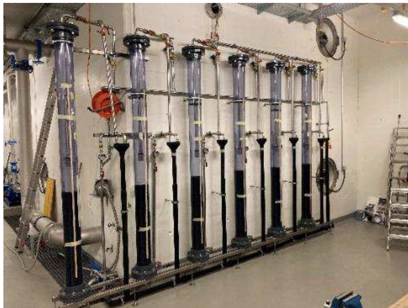
Photo : essai pilote d'abattement des métabolites du chlorothalonil en cours à l'usine de Cudrefin
